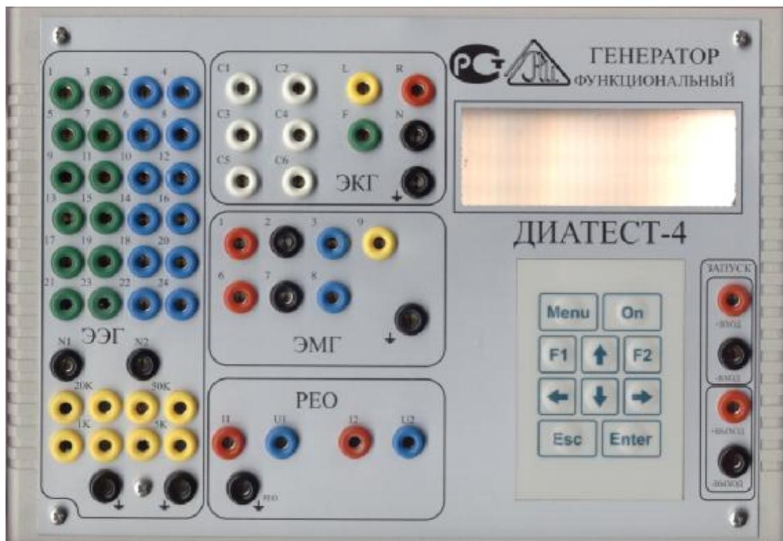
Рис. 5.1. Схема размещения разъемов и лицевая панель генератора
